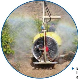
▶ Equipo electropitón instalado en atomizador Bigger
