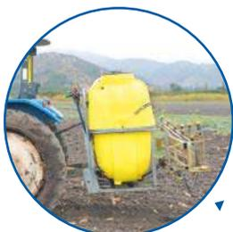
▶ Pulverizador suspendido en tractor
