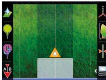
Marcando el perímetro se puede calcular el área y dividir gráficamente, de manera automática, la parte interna (verde) y externa (marrón) del campo.
