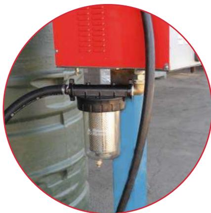
Filtro FG-100 instalado en surtidor controlador GK7
