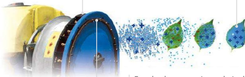
En su borde se encuentra un electrodo especial que produce una alta concentración de electrones en el líquido que pasa, esto produce que se carguen electrostáticamente las gotas.
